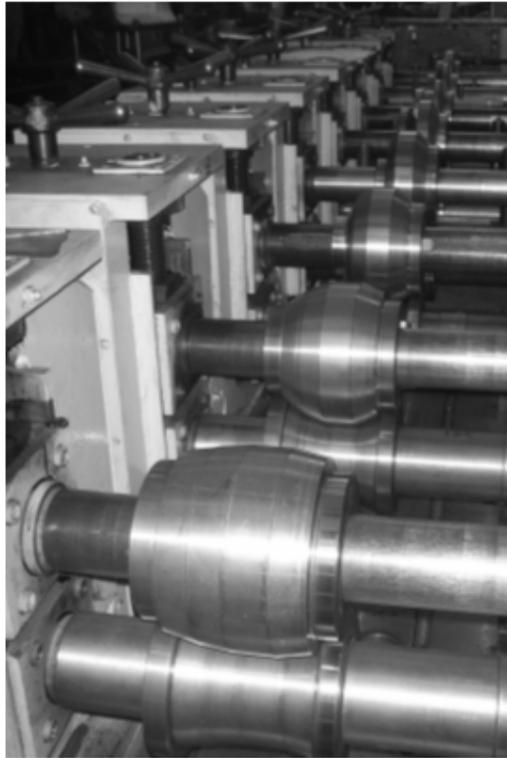
Рис. 10. Профилировочный станок ГПС-350М8 с экспериментальной оснасткой для изготовления армирующего профиля 40,5x27,5x1,5
