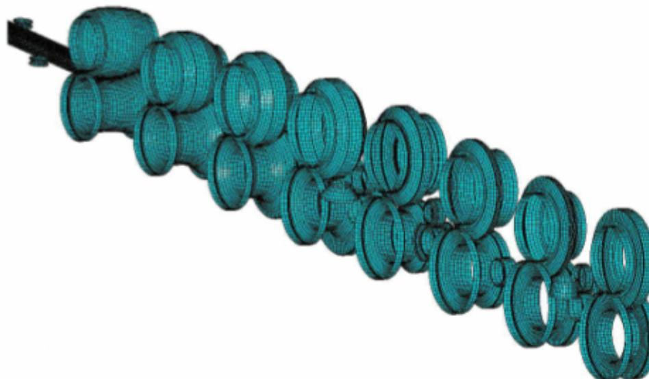
Рис. 3. Конечно-элементная модель роликов и заготовки.
