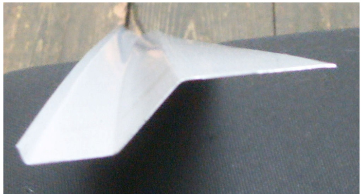
Рис. 6. Скрутка профиля Z-образного сечения
