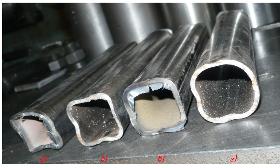
Рис.2.10. Профили, полученные после обжатия по переходам. а) 4-ый проход; б) 3-ий проход; в) 2-ой проход; г) 1-ый проход.
