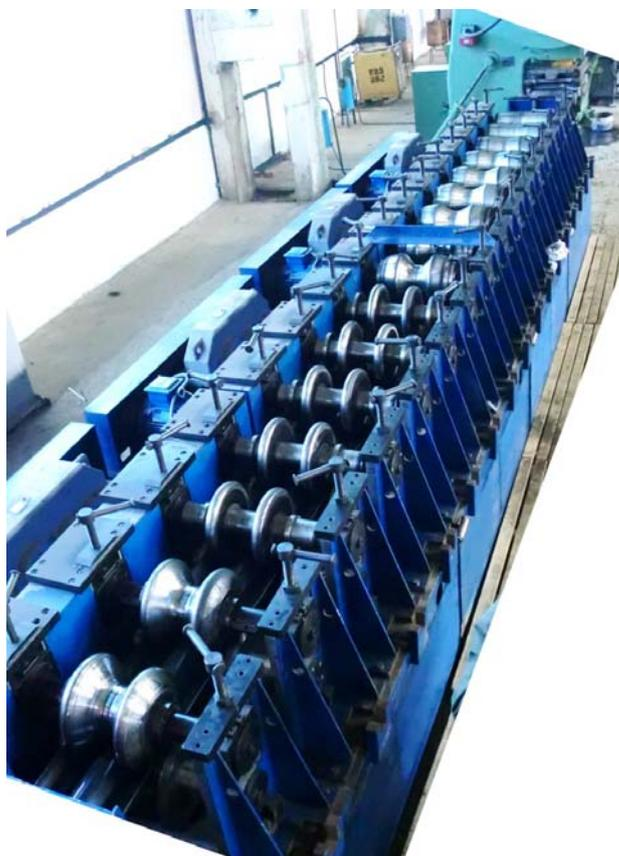
Рис. 3. Гибочно-прокатный стан ГПС500-М16
