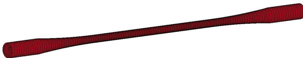
Рис. 2. Исходный образец из материала ВТ6, моделирование одноосного растяжения
