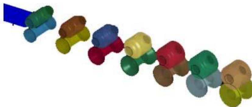
Рис. 4. Моделирование процесса формообразования гнутого профиля швеллерообразного типа
