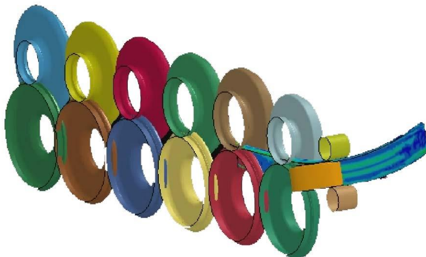
Рис. 10. Моделирование процесса изготовления профиля шпангоут с продольной кривизной
