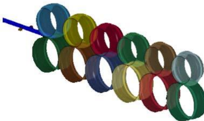
Рис. 5. Моделирование процесса формообразования гнутого профиля корытообразного типа
