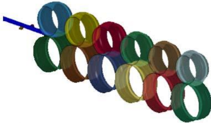
Рис. 7. Моделирование процесса формообразования гнутого профиля корытообразного типа
