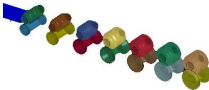
Рис. 6. Моделирование процесса формообразования гнутого профиля швеллерообразного типа
