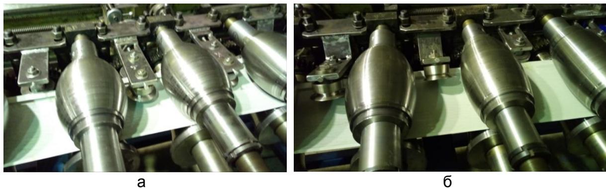
Рис. 1. Проводящие устройства: а – горизонтальные промежуточные ролики, б – наклонные промежуточные ролики.
