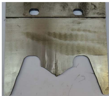
Рис. 4. Практические испытания по результатам моделирования: а – испытуемый нож, б – нож после 15 тыс. ударов, в – сечение профиля после резки в штампе стандартным способом
