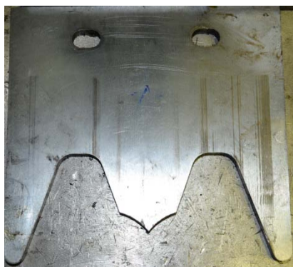
Рис. 4. Практические испытания по результатам моделирования: а – испытуемый нож, б – нож после 15 тыс. ударов, в – сечение профиля после резки в штампе стандартным способом
