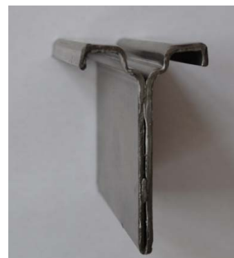
Рис. 4. Практические испытания по результатам моделирования: а – испытуемый нож, б – нож после 15 тыс. ударов, в – сечение профиля после резки в штампе стандартным способом
